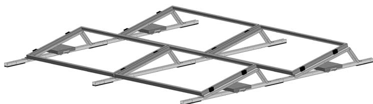
Placez les panneaux sur les triangles de montage et fixez-les avec les étriers finaux et intermédiaires appropriés. Les instructions de fixation pour les modules PV doivent toujours être respectées. Toutes les illustrations dans ce manuel sont purement illustratives.
