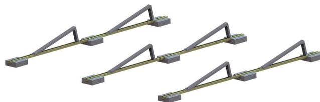
**ATTENTION !** Des socles en béton doivent toujours être placés à tous les endroits décrits ci-dessus. L'absence d'un ou plusieurs socles en béton pourra engendrer de graves problèmes de stabilité.
