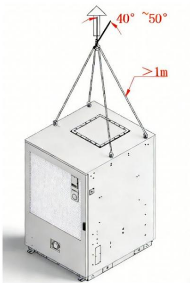
Figure 5-7 Exigences d'installation de levage
