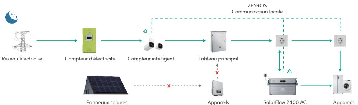
Pendant la journée, SolarFlow 2400 AC alimente votre maison en énergie solaire et stocke l'excédent dans la batterie. Le soir, la batterie fournit de l'énergie à votre maison via le SolarFlow 2400 AC. Cette gestion énergétique efficace réduit votre dépendance au réseau et vous permet de réaliser des économies.
